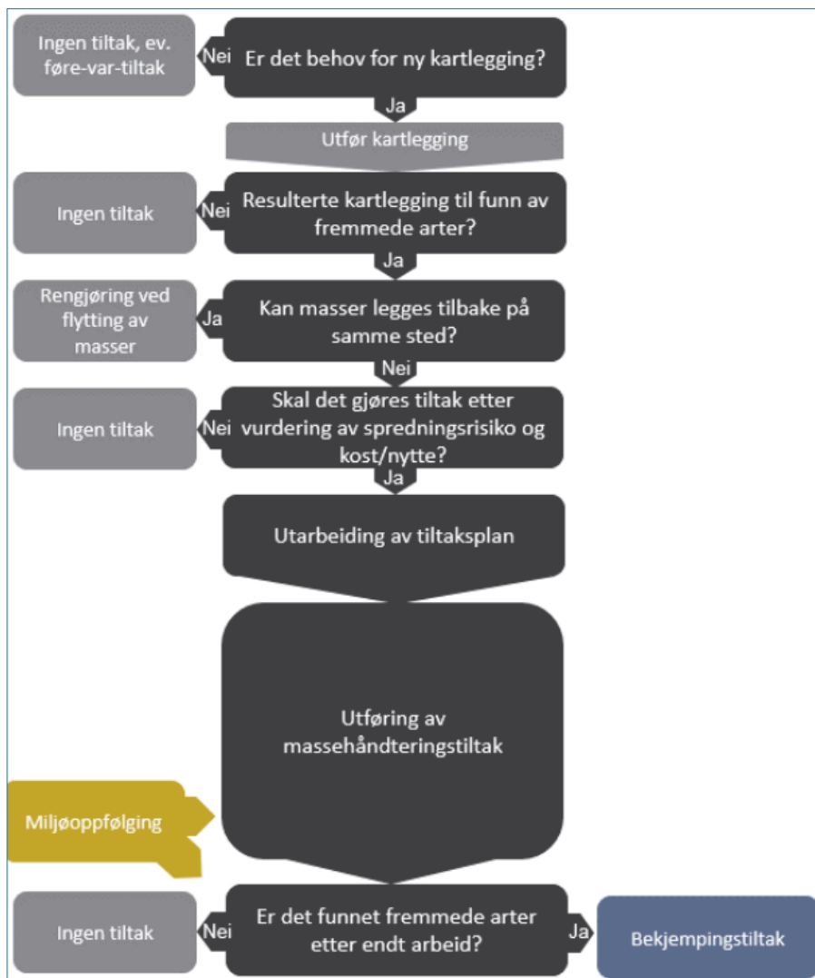
Figur 5: Flytskjema som beskriver de ulike trinnene i et bygge- og anleggsprosjekt for å håndtere fremmede arter. Figuren er kopiert fra veileder M-982 (Sweco Norge AS, 2018).
