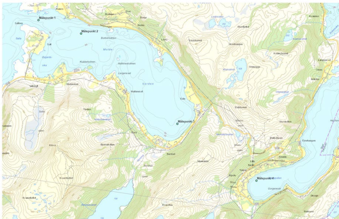
Figur 11-6 Strømhastigheter utført ved målepunkt 3 (entringsområde Moldefjorden) og målepunkt 4 (entringsområde Kjødepollen) ble brukt som inputs in CORMIX modellen. Strømmålingene ble utført av Multiconsult i 2022 [21, 22].
