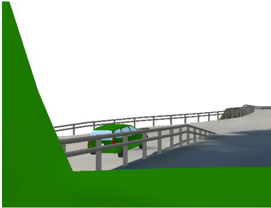
Sikt ut frontruta (personbil frå Mannseidet, 40 m frå krysset) – stålrekkverk
